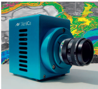
2 Digitale NIR-Kamera Xeva-CL-FPA-2.5-320-TE4 von Xenics deckt mit ihrem vierstufig thermoelektrisch gekühlten Focal Plane Array (320 x 256 Pixel) den erweiterten Wellenlängenbereich von 0,85 bis 2,5 \mu\text{m} ab
