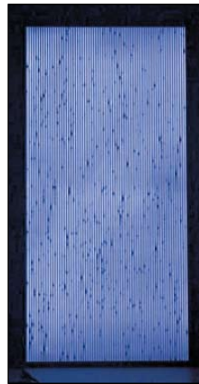
Bild 3: Elektrolumineszenzaufnahme eines CGIS-Panels mit empfindlicher SWIR-Kamera zeigt die typische Nadelstreifenstruktur mit dunklen Fehlstellen, die auf lokale Kurzschlüsse hinweisen können (Quelle: Photovoltaik-Institut, Berlin)
